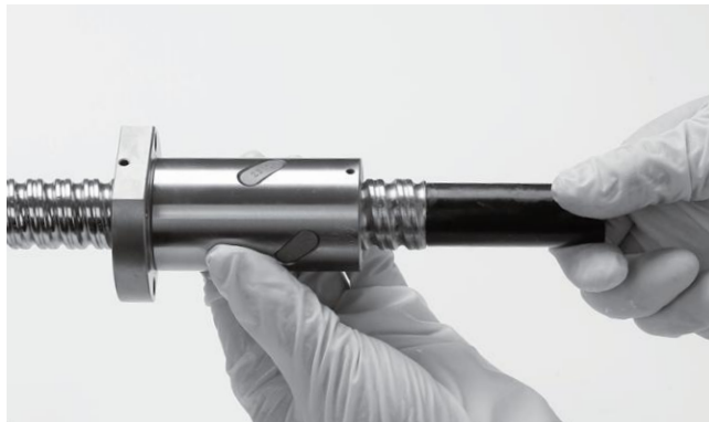
4. 将螺母全程都转入丝杠上。 注意！确认螺母全部行程都转入丝杠后才能将转换管移开。
