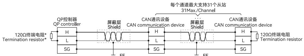
\*注：内置终端电阻，通过终端电阻拨码开关启用。
