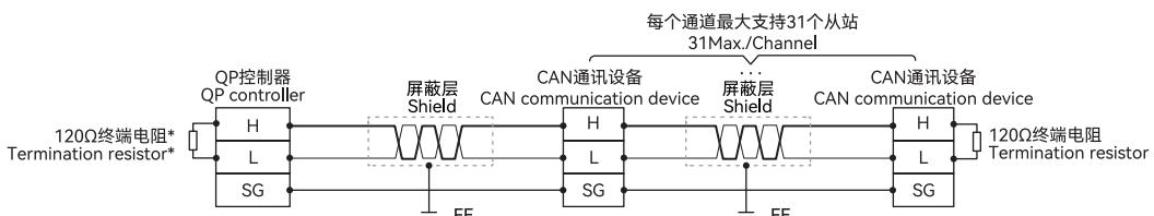
\*注：内置终端电阻，通过终端电阻拨码开关启用。
