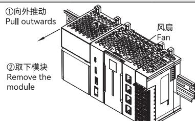
警告：控制器内置风扇，用户不可自行拆卸，遇到风扇故障请联系禾川售后进行更换。
