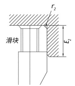
表3.3 HRH型导轨的安装面尺寸设计要求(mm)
