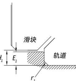
表3.2 HBS型导轨的安装面尺寸设计要求(mm)
