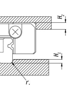
微型导轨除了规格7以外都可设置底部密封垫片。客户在选用底部密封垫片时，需注意滑块间隙( $H_1$ )进一步变小；而当侧边有靠肩面时，侧边靠肩面的高度，不可大于间隙值( $H_1$ )，以避免滑块在运行时干涉到侧边靠肩面。
