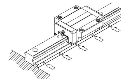
(5) 使用扭矩扳手，将固定螺栓按规定的扭矩拧紧。推荐的螺栓拧紧顺序：从中央位置开始向两端按顺序拧紧，如果轨道不长，也可以从一端开始依次拧紧。
