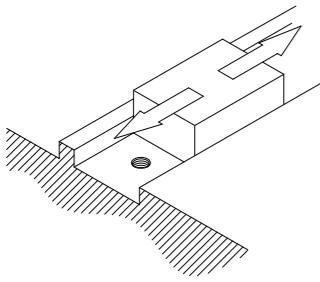
(2) 将直线导轨轻轻地放置于底座上后，使直线导轨轨道与安装面轻轻地靠紧。(注意要将轨道的基准面与底座的定位靠肩的基准面一侧对上)
