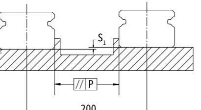
表3.13 HMN/HMW上下平行度容许误差( $S_1$ )(μm)
