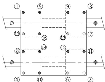
**■ 3.8 安装的扭矩管理与检测方法及其他****■ 3.8.1 固定螺栓的安装规定扭矩值**
