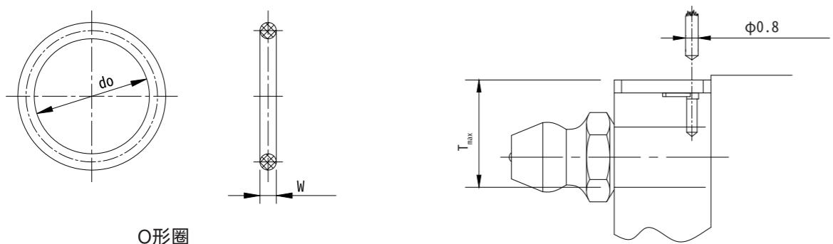
表1.17 各类导轨型号所对应的O形圈
