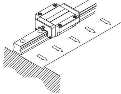
(3) 试拧紧安装螺栓以确认螺栓孔是否吻合，并将轨道底部基准面固定于工作台底部的安装面。
