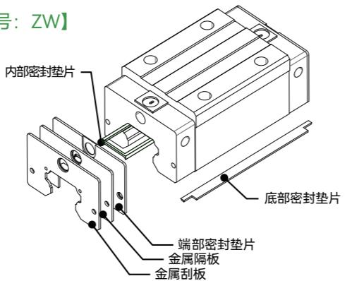
下表中列出了上述防尘密封配置的具体组成以及相应的规格型号。
