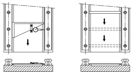
**■ 3.7.3 无侧面定位靠肩时的安装步骤**
