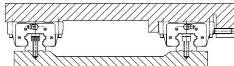
**(1) 基准轴导轨的安装****【借用临时基准面法】**
