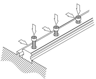
(4) 然后依次将轨道侧面的止动螺栓拧紧，使轨道基准边与定位靠肩面紧靠，确定导轨的安装位置。
