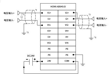
图 8 HCMX-AD04S-D 模块端子接线图
