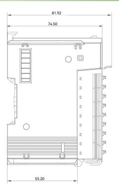
图 6 HCMX-AD04S-D 模块尺寸图(单位: mm)
