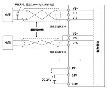
图 7 HCMX-AD04S-D 模块内部接线图
