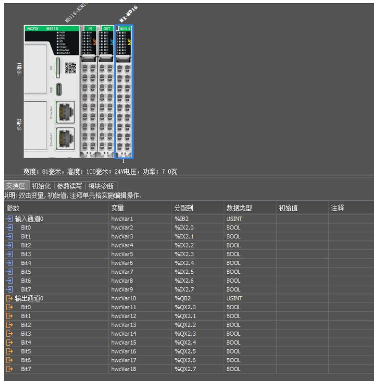
3) 单击主机，“输入输出”界面，控制器运行到停止时，可以设置模块输入点停止更新或继续更新和设置模块输出点保持原来的状态（停止时可以继续控制模块的输入）或者清除（停止时不可以继续控制模块的输出）：
