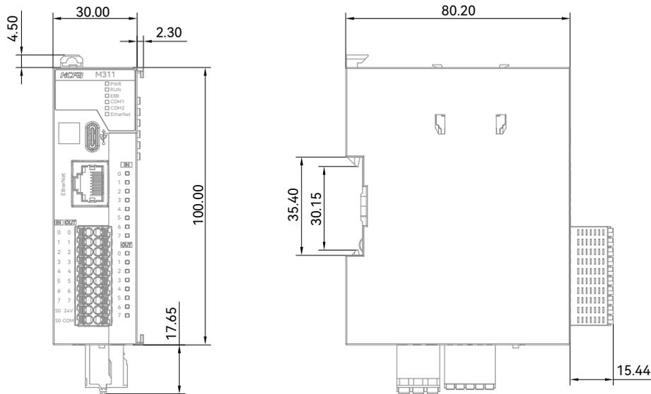
图 8 HCM311-16MT4-D 控制器安装尺寸 (单位: mm)
