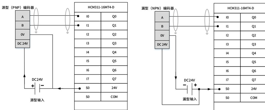
图 12 本地输入作为高速输入外部接线图
