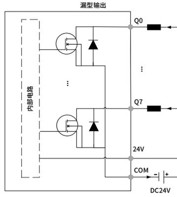
图 10 本地输出内部电路简图
