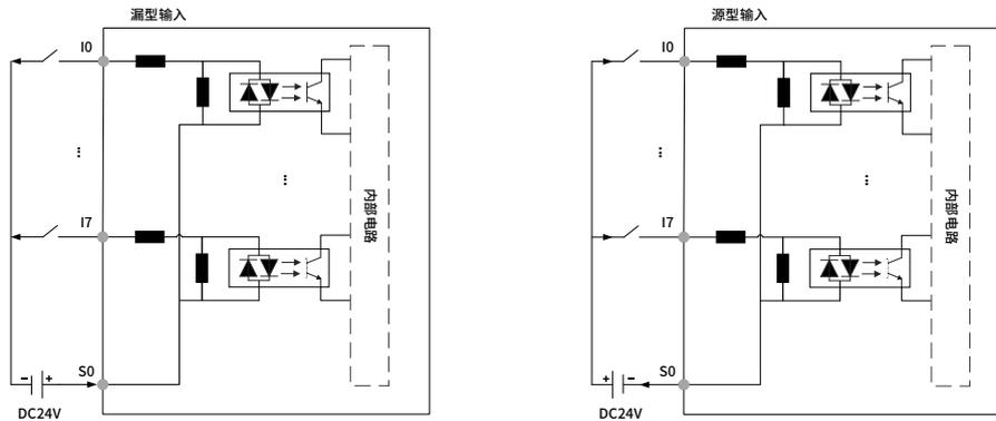
图 9 本地输入内部电路简图
