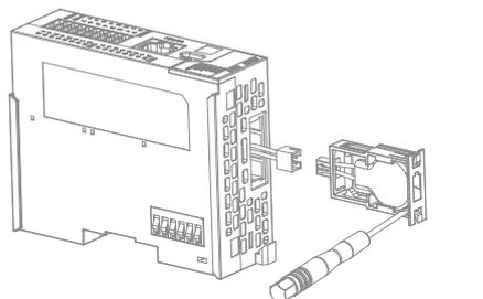
用一字螺丝将电池从卡槽内拆除
