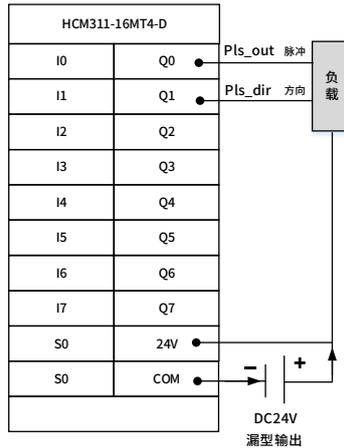
图 13 本地输出作为高速输出外部接线图
