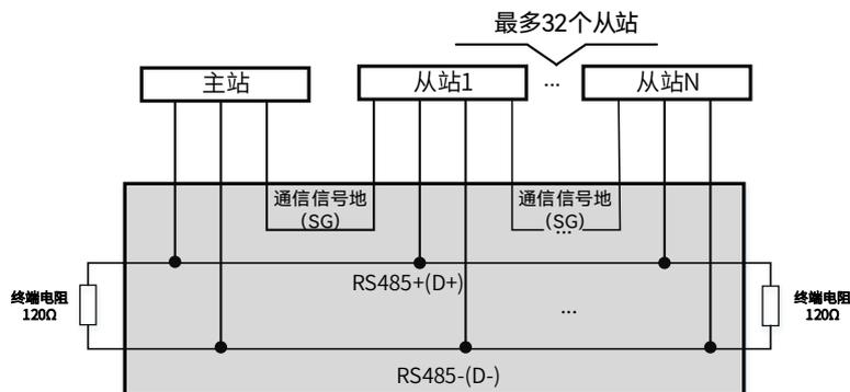
图 15 RS485 通讯网络硬件连接示意图
