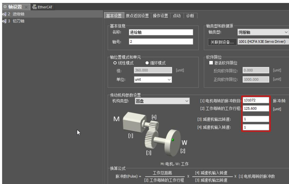
虚拟伺服轴和进给轴为 1:1 的电子齿轮关系，虚拟伺服轴轴 1 参数和进给轴轴参数相同，如下图所示。
