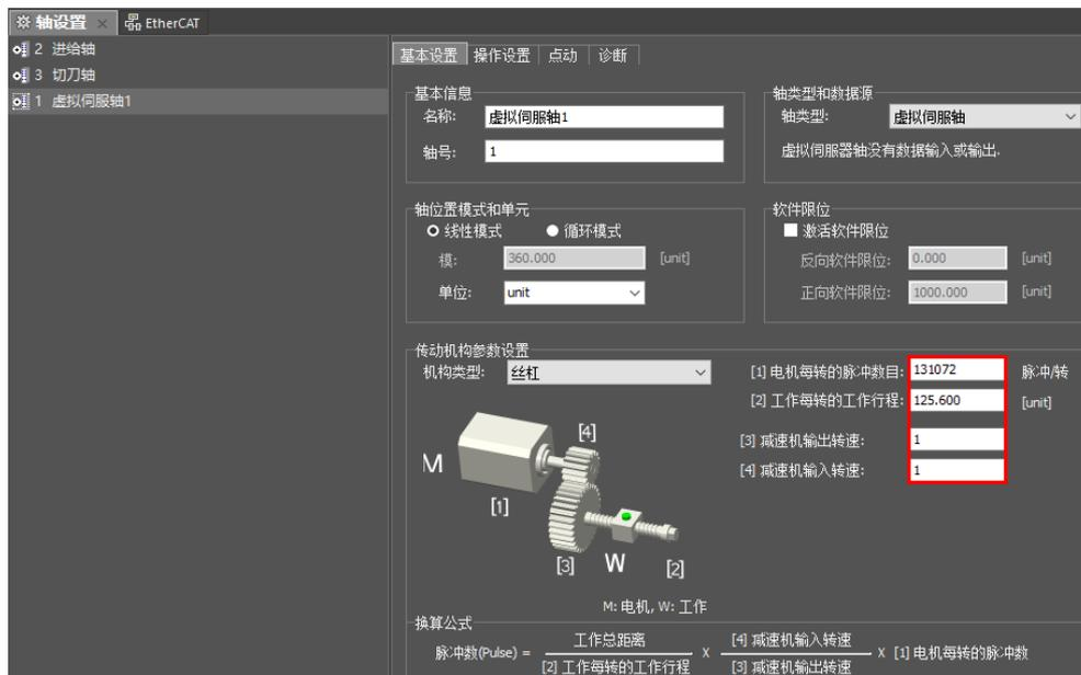
切刀轴轴 3 参数设置如下图所示，“工作每转的工作行程” $=2*3.14*10$ （切刀轴半径） $=62.8$ 。
