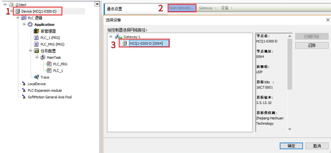
4) 完成和 Q1 的通讯后, 在左侧树形菜单找到 Device→添加设备→EtherCAT Master SoftMotion
