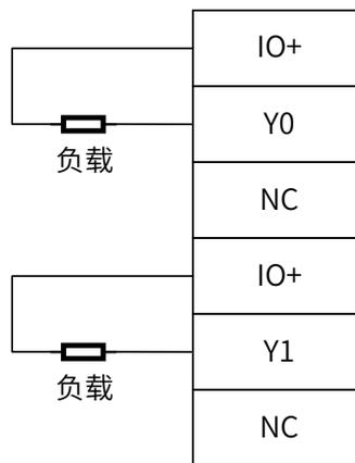
图 19 HCNXE 系列模块 NPN 输出外部接线图
