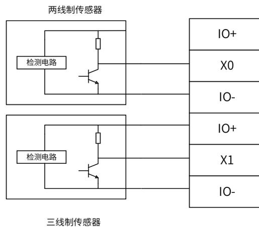
图 17 HCNXE 系列模块 NPN 输入外部接线图
