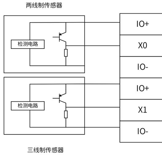
图 18 HCNXE 系列模块 PNP 输入外部接线图
