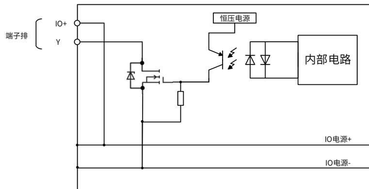
图 16 HCNXE 系列模块输出内部电路图
