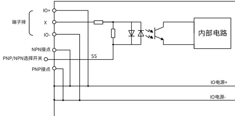
图 15 HCNXE 系列模块输入内部电路图
