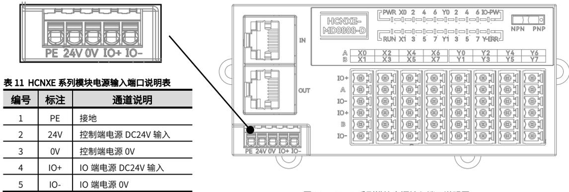
图 11 HCNXE 系列模块电源输入端口说明图
