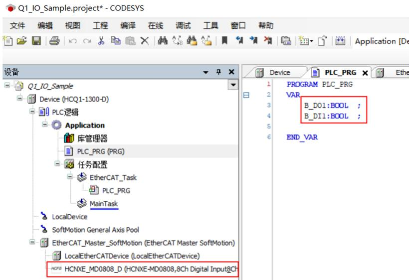
8) 将 HCNxE-MD0808-D 的两组通道分别映射到程序中定义好的变量 B\_DI1 和 B\_DO1，如下
