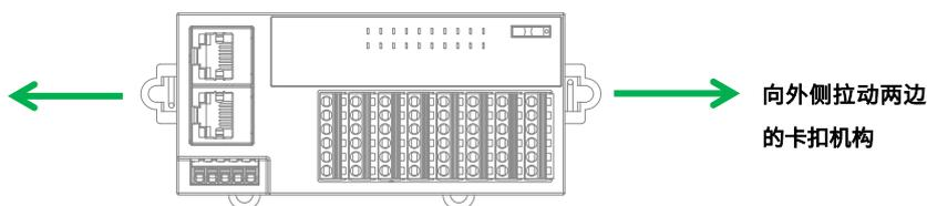
两侧的卡扣内打入两颗 M4 螺丝（过程中允许使用辅助工具，例如：螺丝刀等）。
