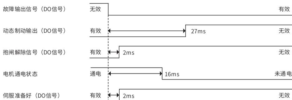
故障停机时, 抱闸解除信号的时序时间, 与电机运行速度有关, 详情见参数说明, 此值最小为 2ms。
