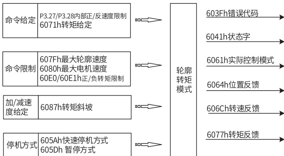
图 5-6 轮廓转矩模式输入输出
