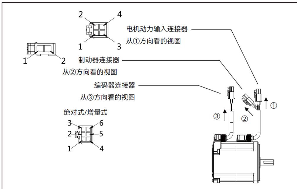
表 2.2.1 电缆侧线材一览 (750W 以下电机)
