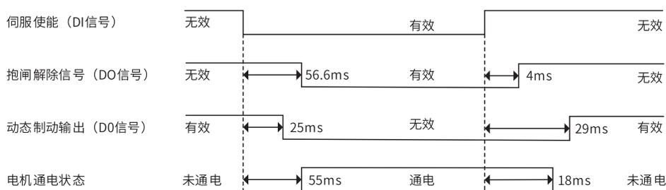
伺服 OFF 停机时, 抱闸解除信号的时序时间, 与电机运行速度有关, 详见参数说明, 此值最小为 4ms。
