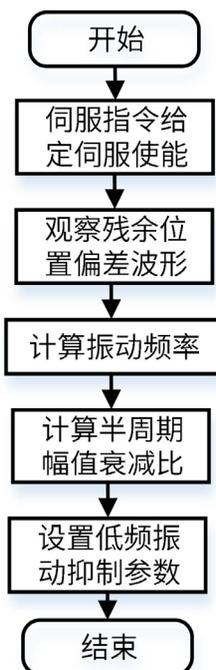
图 3.11 低频抑制功能操作流程
