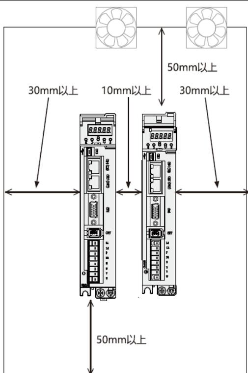
1500W~3000W 驱动器的安装间隔示意图 2
