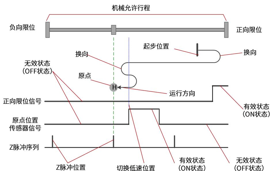
图 5-8 原点模式图示中各种图标的意义
