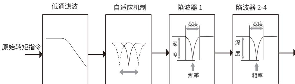
图 3.8 陷波滤波器在伺服控制中的作用
