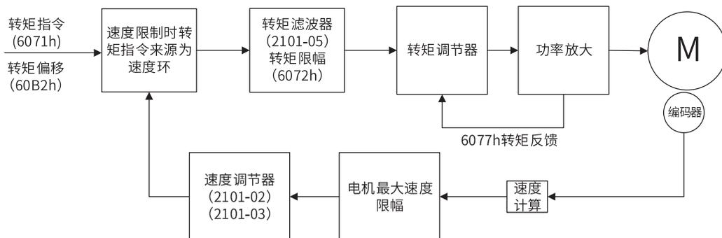
图 5-45 周期同步转矩模式控制框图
