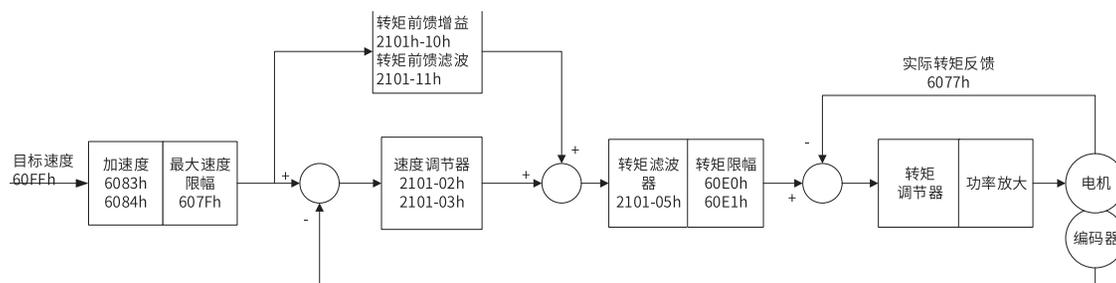
图 5-3 轮廓速度模式控制框图
