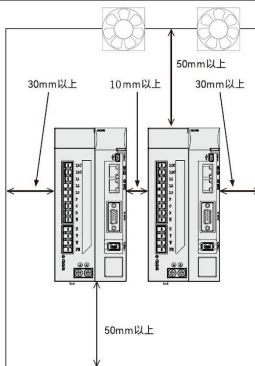
• 按垂直方向安装驱动器。安装各功率驱动器请按以下说明：100W~400W功率的驱动器时，请使用2个M4螺丝固定。安装750W~1000W功率的驱动器时，请使用2个M5螺丝固定。安装1500W~3000W功率的驱动器时，请使用3个M5螺丝固定。
