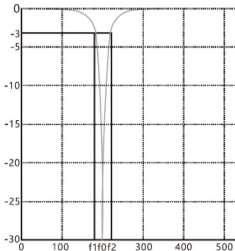
图 3.6 陷波滤波器幅频特性
