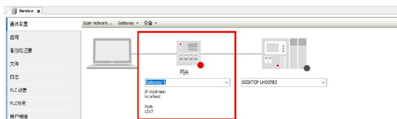
PC 右下角找到 CODESYS 图标, 右击选择 StartGateway, 启动网关, 执行扫描和添加
