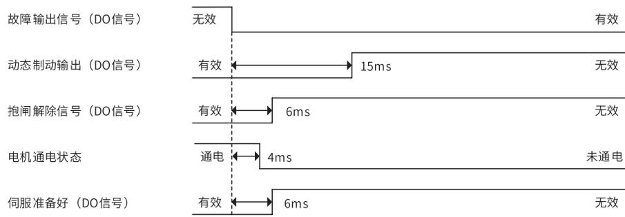
故障停机时, 抱闸解除信号的时序时间, 与电机运行速度有关, 详情见参数说明, 此值最小为 6ms。
