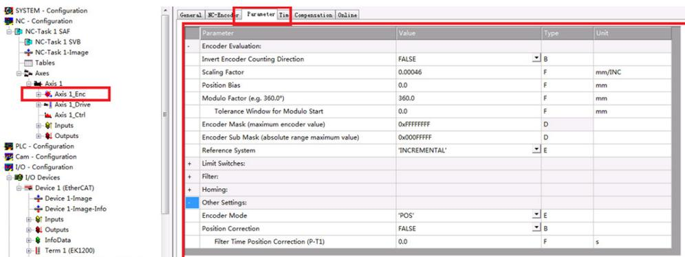
Invert Encoder Counting Direction: 编码器计数方向取反, 默认为 False, 如果希望电机正向转动的而位置反馈值减小, 就需要置为 True, 同时也应将电机极性取反;
