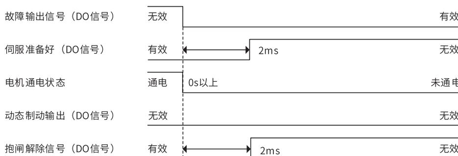
故障停机时, 抱闸解除信号的时序时间, 与伺服参数 P04.52、P04.53 设置及电机运行速度有关, 详情见参数说明, 此值最小为 2ms。
