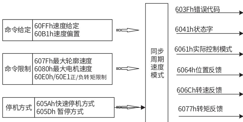
图 5-44 周期同步速度模式输入输出
