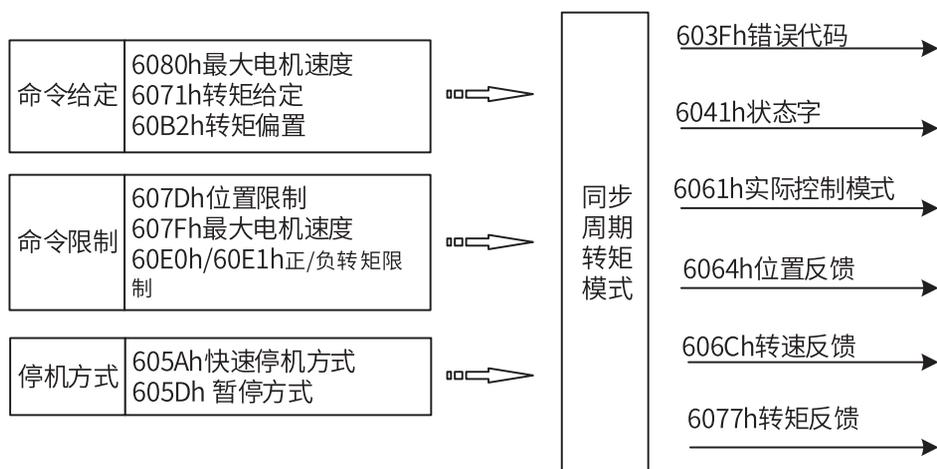
图 5-46 周期同步转矩模式输入输出
