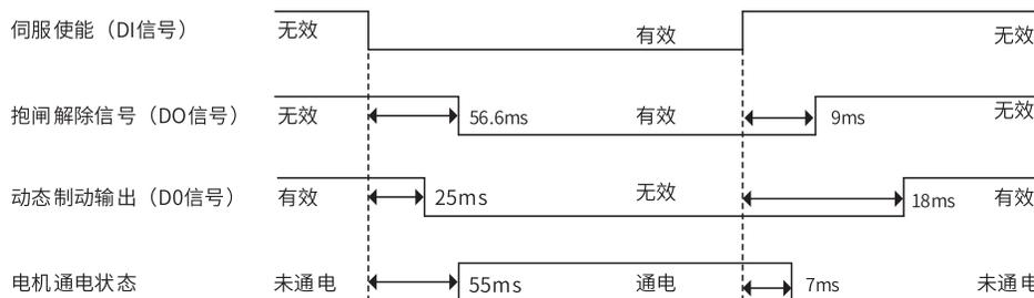
伺服 OFF 停机时, 抱闸解除信号的时序时间, 与电机运行速度有关, 详见参数说明, 此值最小为 9ms。
