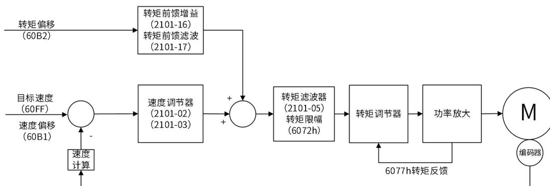
图 5-43 周期同步速度模式控制框图
