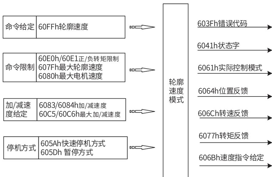
图 5-4 轮廓速度模式输入输出
