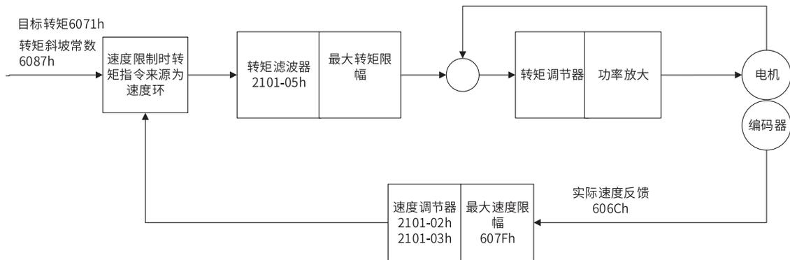
图 5-5 轮廓转矩模式控制框图
