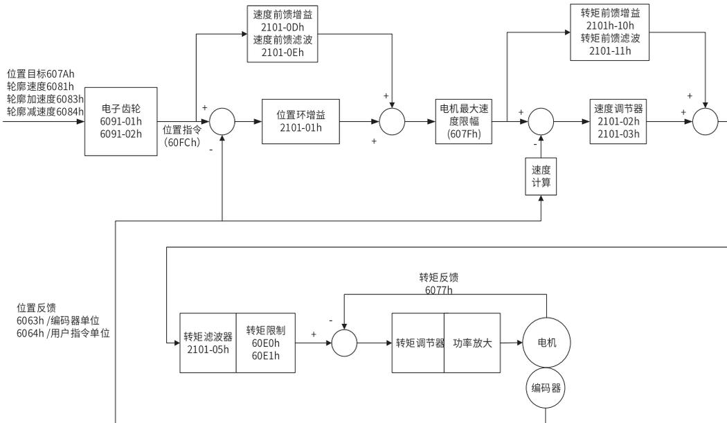
图 5-1 轮廓位置模式控制框图
