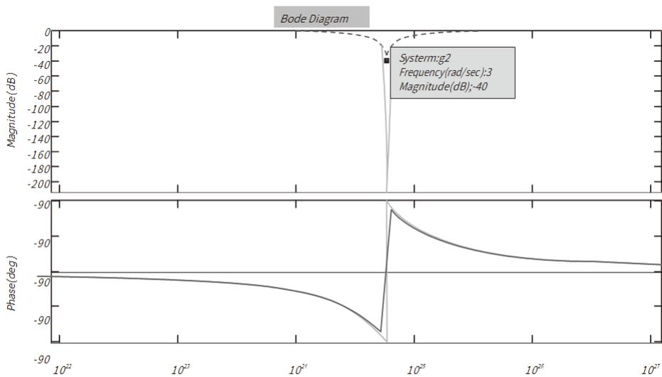
图 3.7 陷波滤波器深度设分别为 1 和 0 时的频域响应曲线
