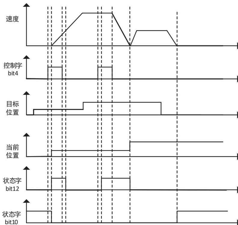
当 6040h 控制字 bit5 是 1 时, 如果变更动作中的定位数据, 将中止正在执行的指令, 立即执行最新的指令, 如下图:
