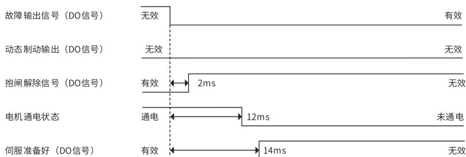
故障停机时, 抱闸解除信号的时序时间, 与电机运行速度有关, 详情见参数说明, 此值最小为 2ms。
