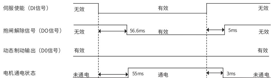
伺服 OFF 停机时, 抱闸解除信号的时序时间, 与伺服参数 P04.52、P04.53 设置及电机运行速度有关, 详见参数说明, 此值最小为 5ms。
