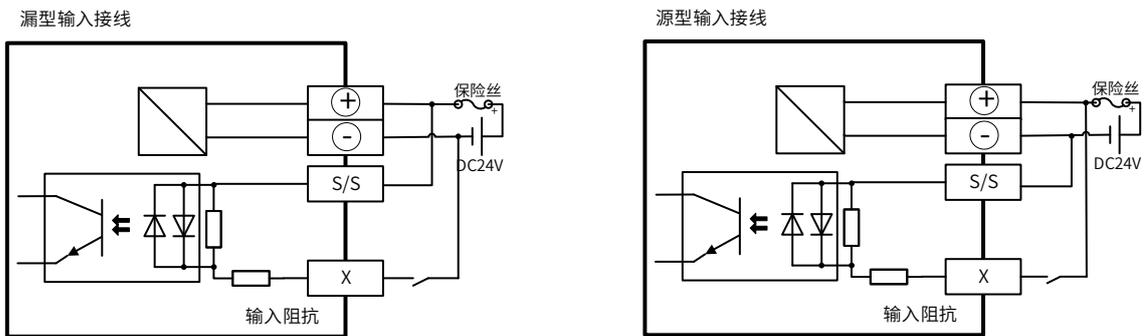
图 7 HCR8C-32MT-D 输入接线图
