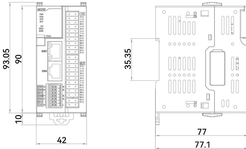
图 6 HCR8C-32MT-D CPU 模块安装尺寸 (单位: mm)
