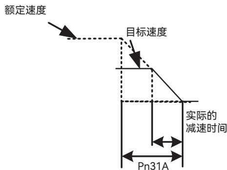
图 5-7 减速停车的减速时间图
