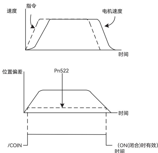
图 5-18 /COIN 信号的输出时间图
