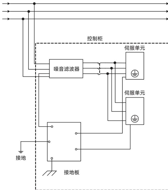
图 2-31 噪音滤波器与控制柜接地图
