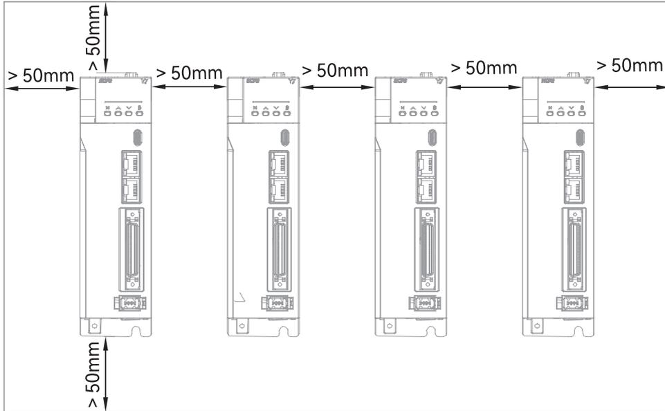
图 1-9 Y7S 伺服单元机柜安装示意图
