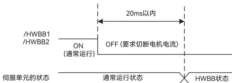
图 5-31 基极封锁功能运行时序图
