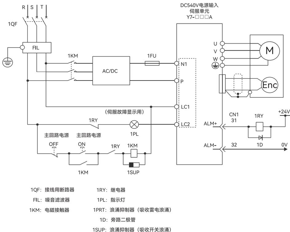
图 2-9 DC540V 输入型 HN-Y7 □□□□□ T-S 三相接线图 2
