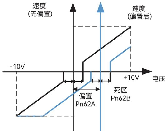
图 5-16 速度模拟量偏置和死区关系图
