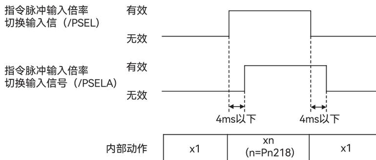
图 5-17 指令脉冲输入倍率时序图
