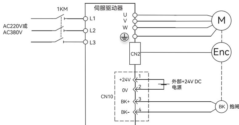
图 2-23 抱闸 CN10 接线图
