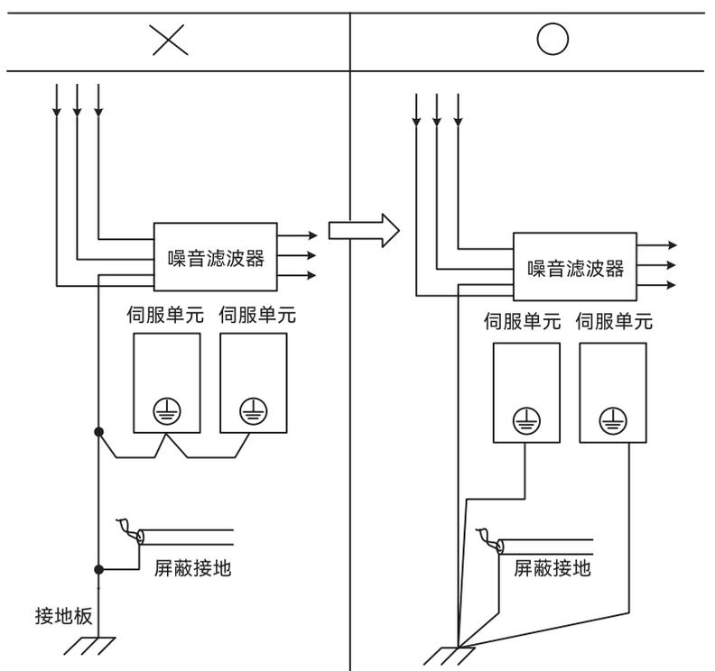
图 2-30 噪音滤波器接地图
