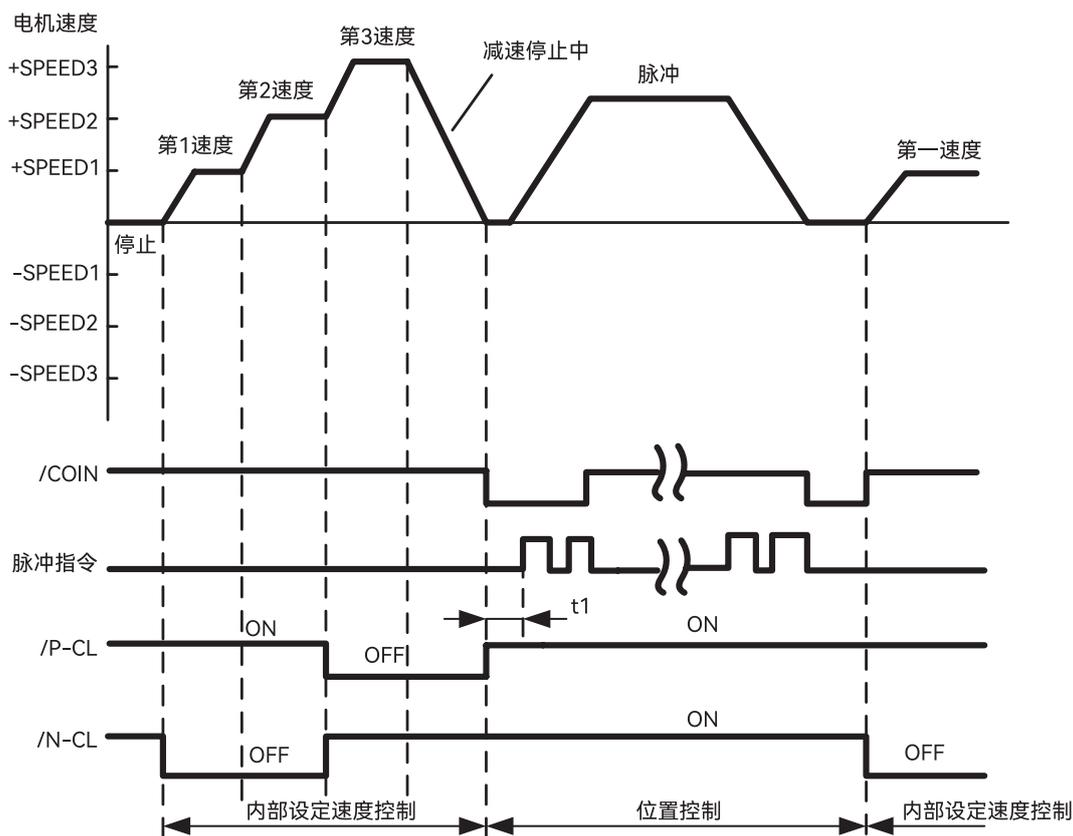
图 5-25 内部速度控制 + 软启动位置控制的运行图
