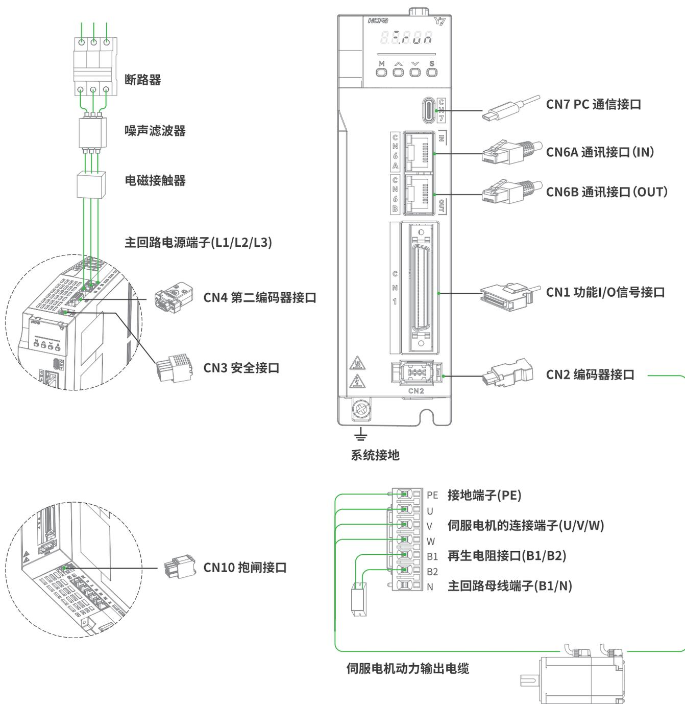
图 2-1 连接器型端子驱动器端口配线图
