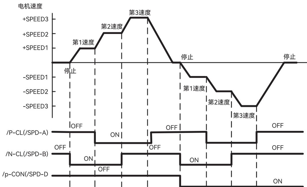
图 5-24 内部设定速度控制和软起动组合使用时的运行方法图
