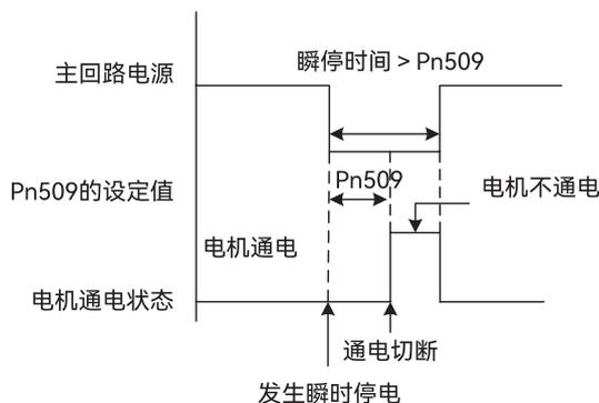
图 5-9 主回路电源和电机通电状态图（Pn509 的设定值  $<$  瞬停时间）
