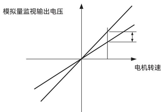
图 7-2 电机转速监视的增益调整示例图
