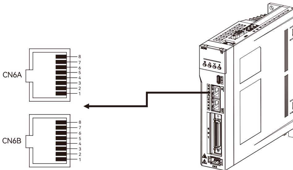
图 2-21 端口 CN6 RJ45 接口引脚细节图
