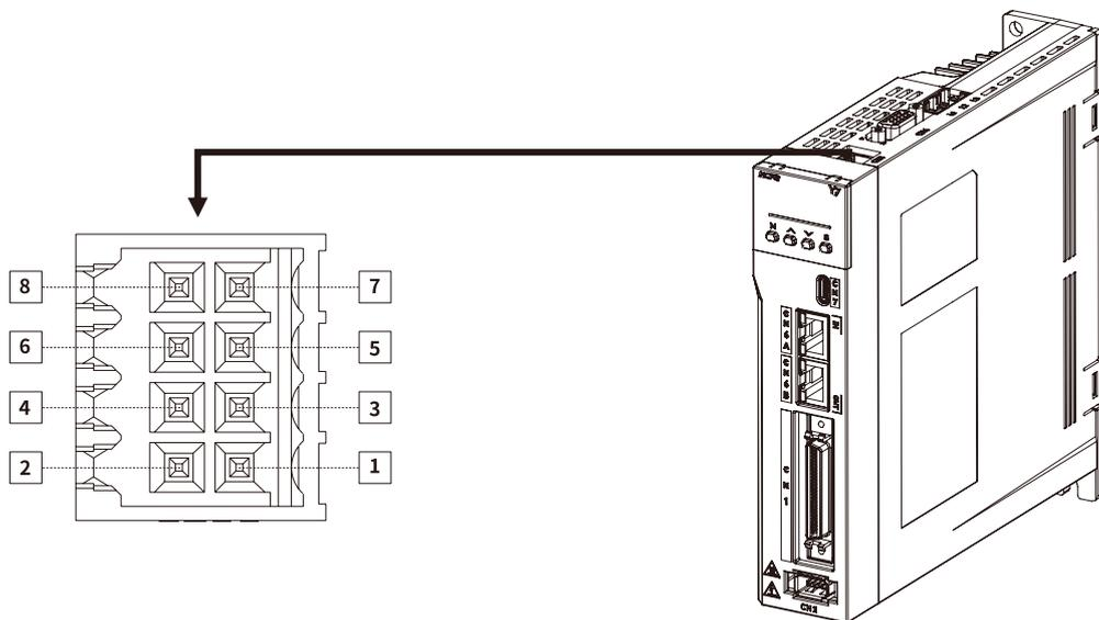
图 2-18 端口 CN3 引脚细节图
