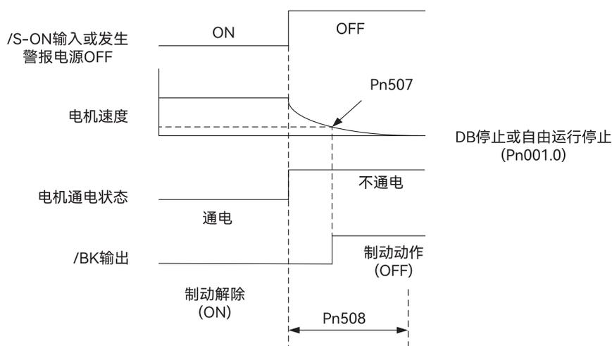
图 5-5 制动器信号 (/BK) 的输出时序图 1(电机旋转时)
