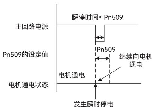
图 5-8 主回路电源和电机通电状态图（Pn509 的设定值  $\geq$  瞬停时间）
