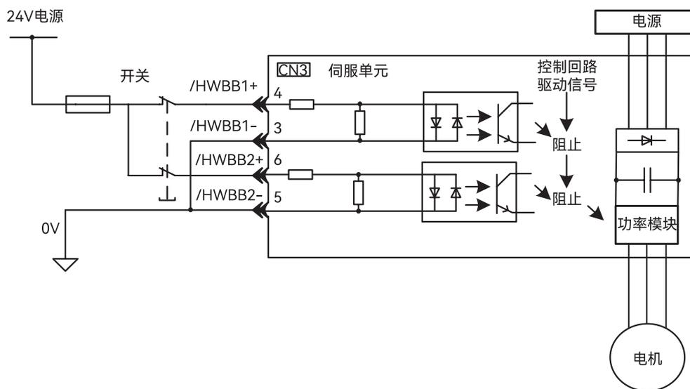
图 5-26 硬接线基极封锁功能图
