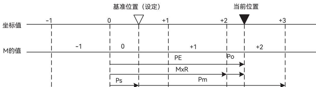
图 5-38 绝对值数据 PM 输出方式图
