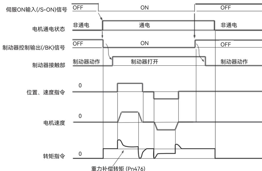
图 5-41 制动器动作时间图
