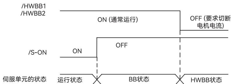
图 5-27 硬接线基极封锁状态时序图
