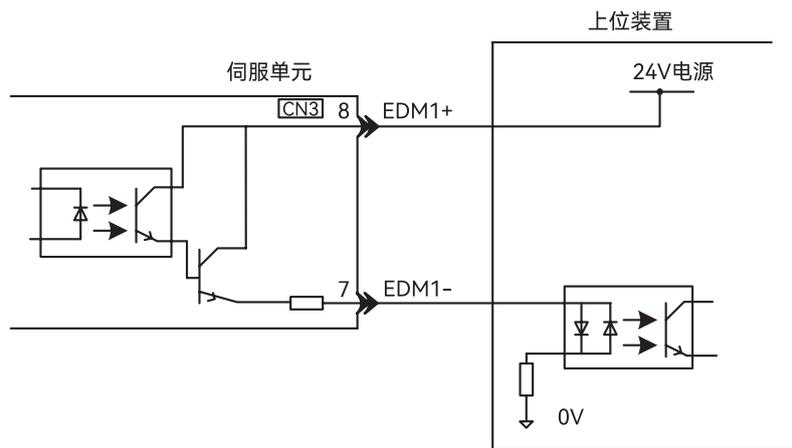
图 5-33 输出信号 (EDM1 信号) 为共发射极输出
