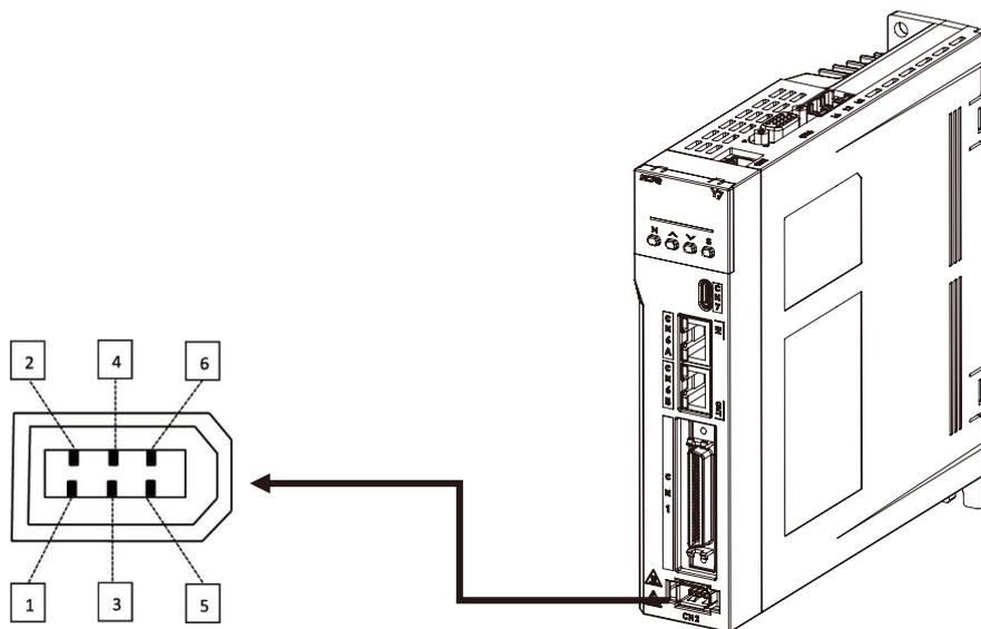
图 2-15 端口 CN2 引脚细节图
