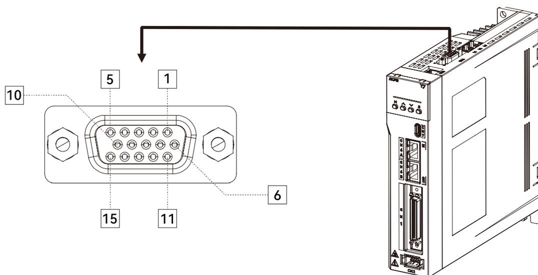
图 2-20 端口 CN4 引脚细节图
