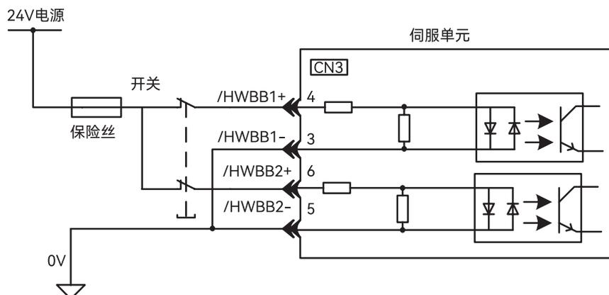
图 5-30 HWBB 输入信号连接示例图
