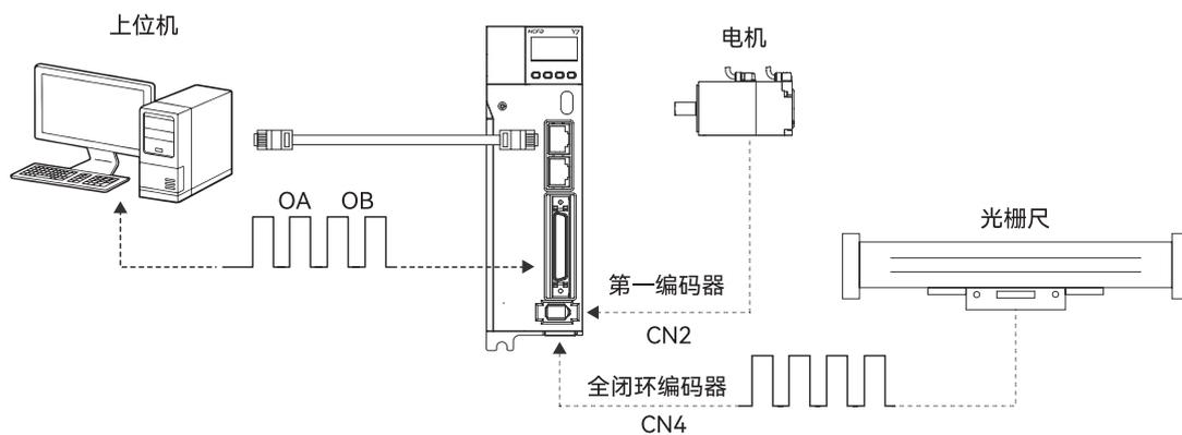
图 9-5 全闭环系统分频脉冲示意图
