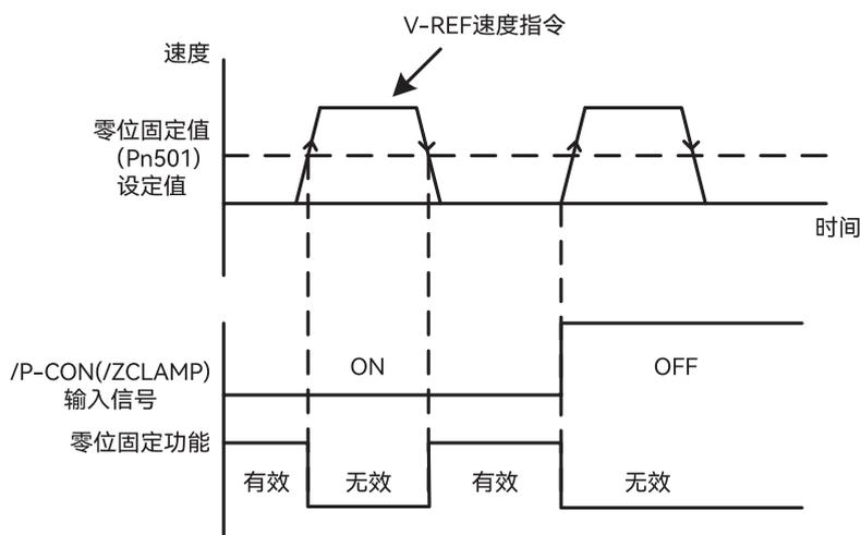
图 5-14 速度指令 (V-REF) 的输入电压低于零位固定值 (Pn501) 设定的速度时间图
