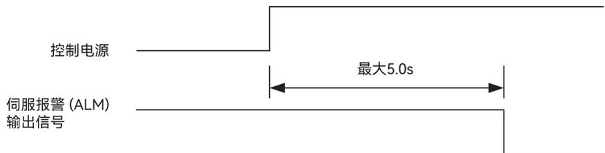
图 2-3 伺服报警输出信号时序图
