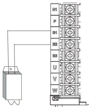
图 2-11 5kw 及以上再生电阻连接 (有 B3)
