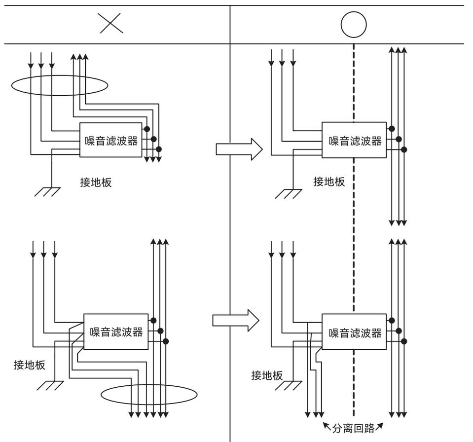
图 2-28 噪音滤波器安装接线图
