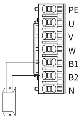
图 2-10 3kw 以下再生电阻连接
