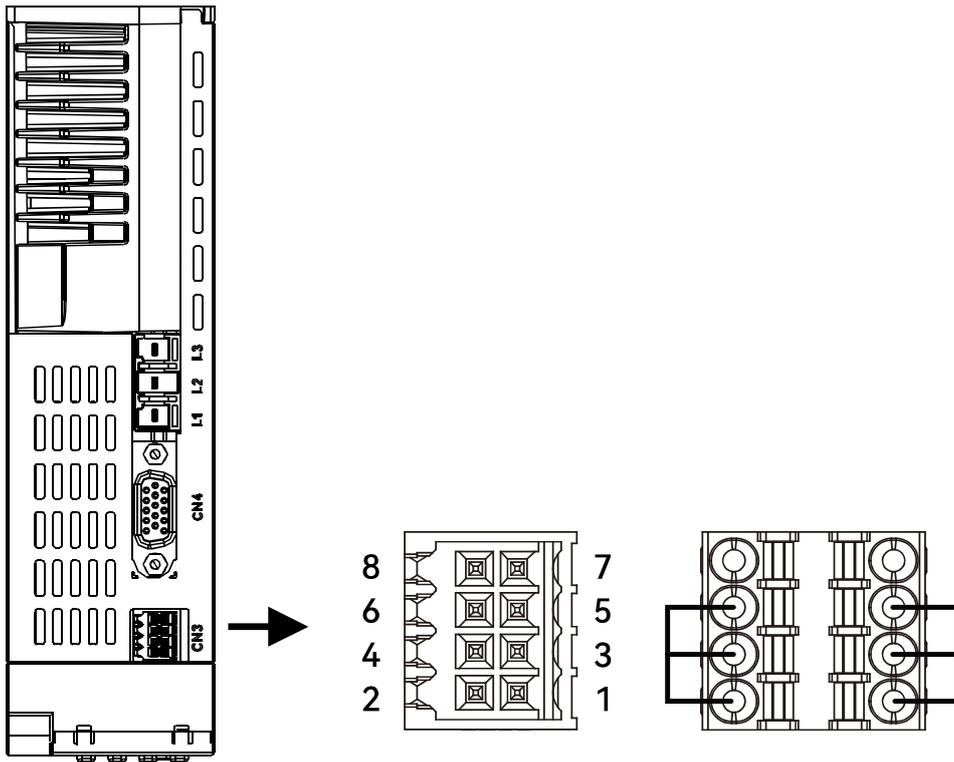
图 2-19 安全端子接线图
