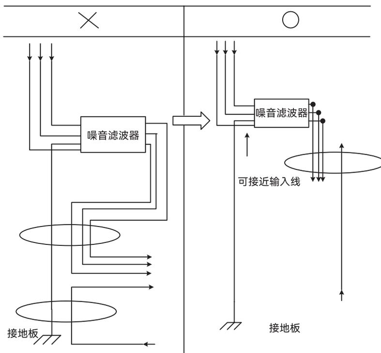
图 2-29 噪音滤波器正确接地图
