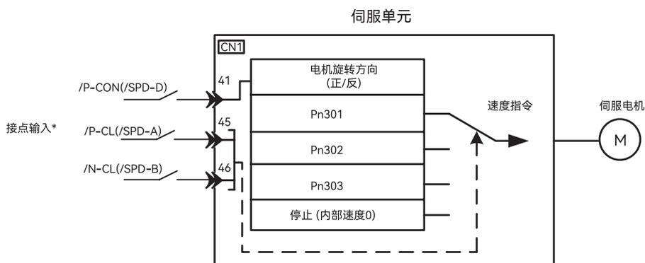
图 5-23 内部设定速度控制图
