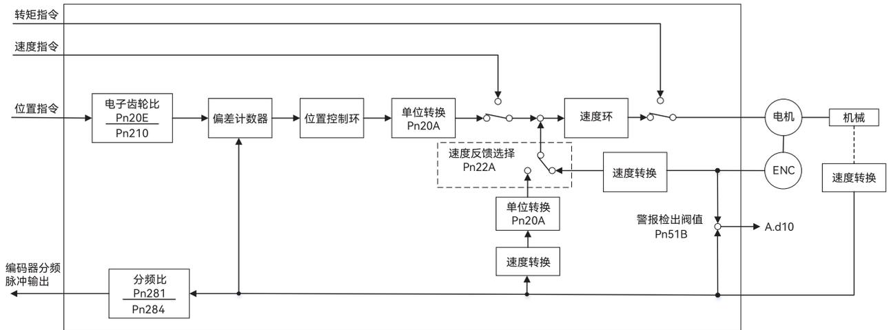
图 9-3 全闭环系统控制框图
