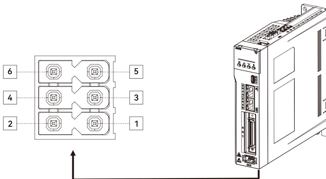
图 2-22 端口 CN10 抱闸输入接口引脚细节图
