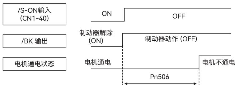
图 5-4 制动器信号 (/BK) 的输出时序图 (电机停止时)
