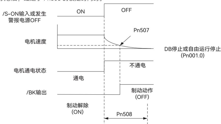
图 5-6 制动器信号 (/BK) 的输出时序图 2(电机旋转时)
