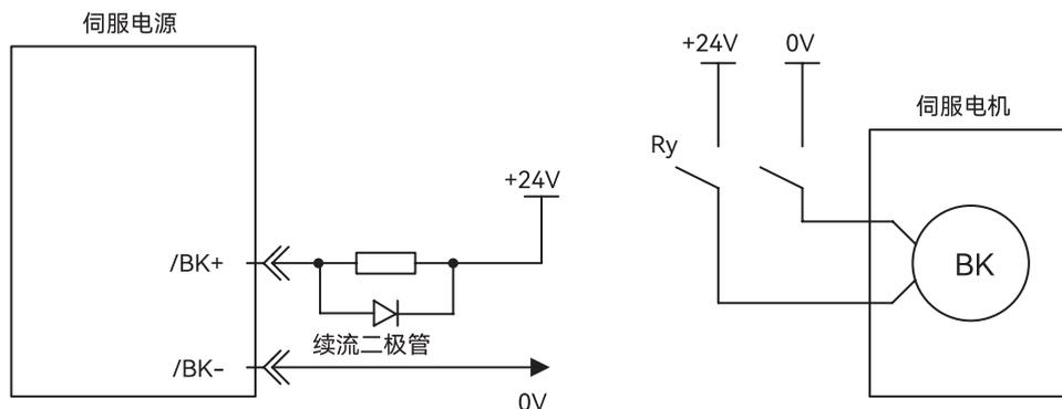
图 2-14 制动器信号连接示例图
