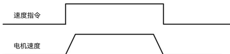
图 5-12 软起动速度指令和电机速度
