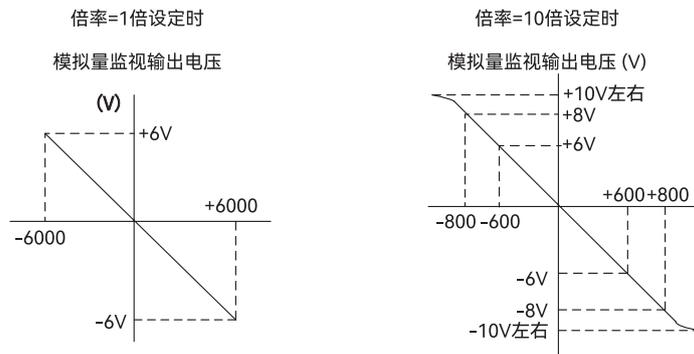
图 6-1 模拟量检测输出
