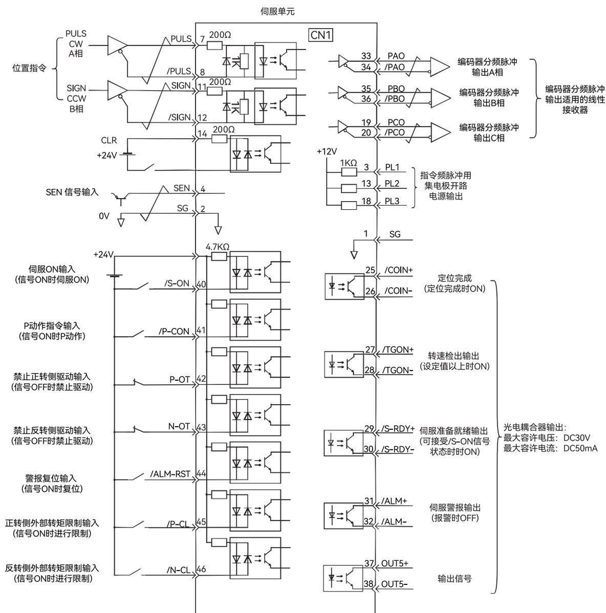
图 2-24 位置控制时的连接示例图 (脉冲型)
