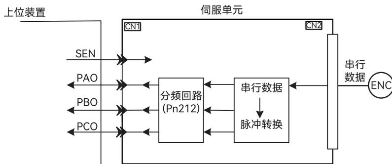
图 5-36 伺服单元输出绝对值数据传输示意图
