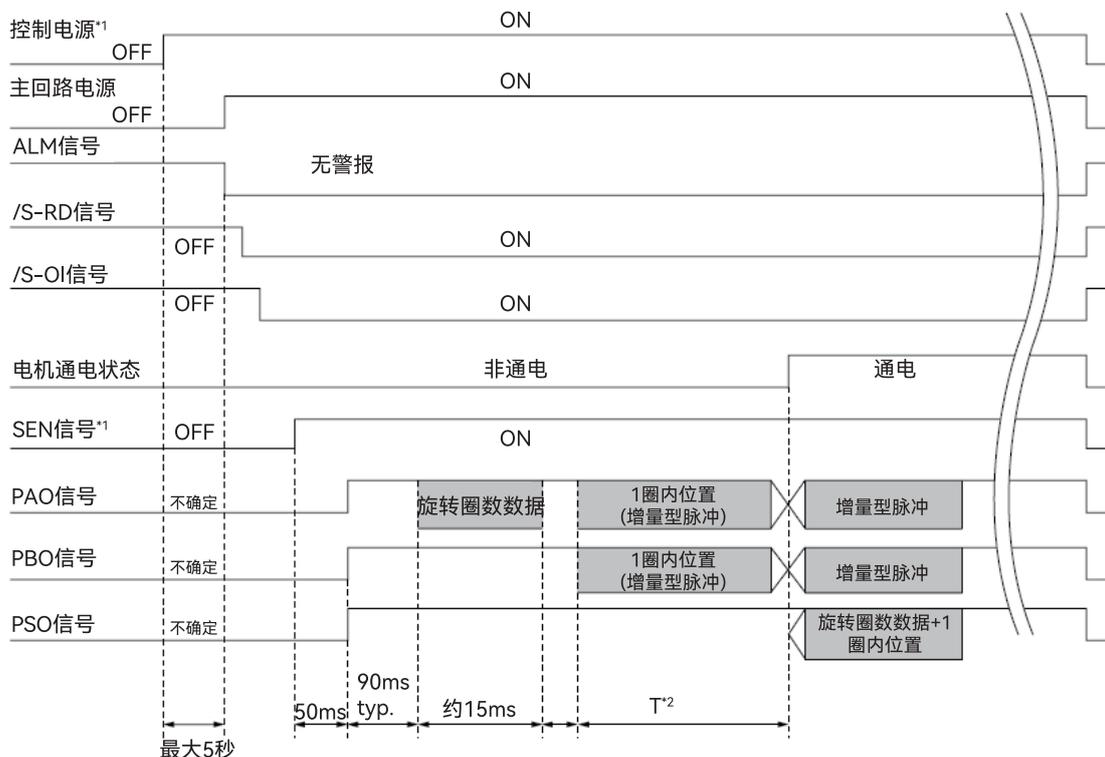
图 5-34 伺服单元输出绝对值数据时时序图
