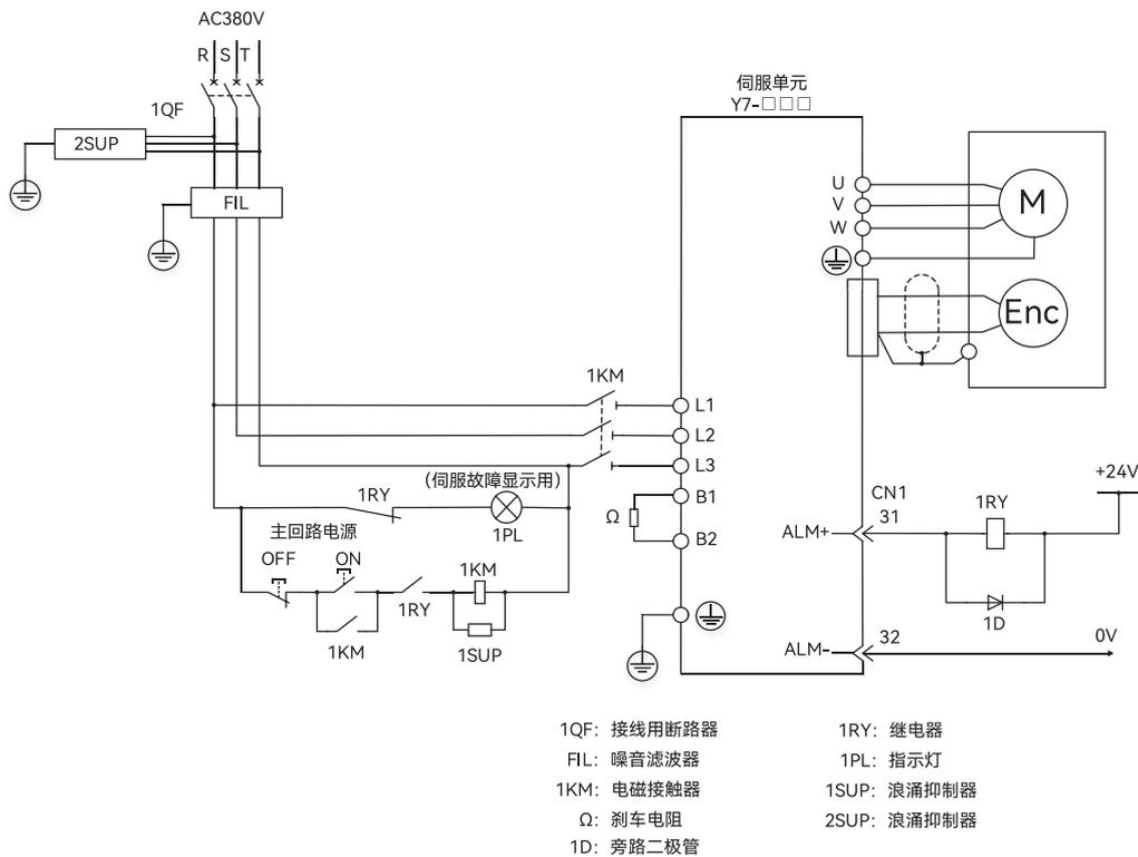
型号: HN-Y7 □□ 500T-S、HN-Y7 □□ 600T-S、HN-Y7 □□ 750T-S、HN-Y7 □□ 111T-S、HN-Y7 □□ 151T-S、HN-Y7 □□ 221T-S
