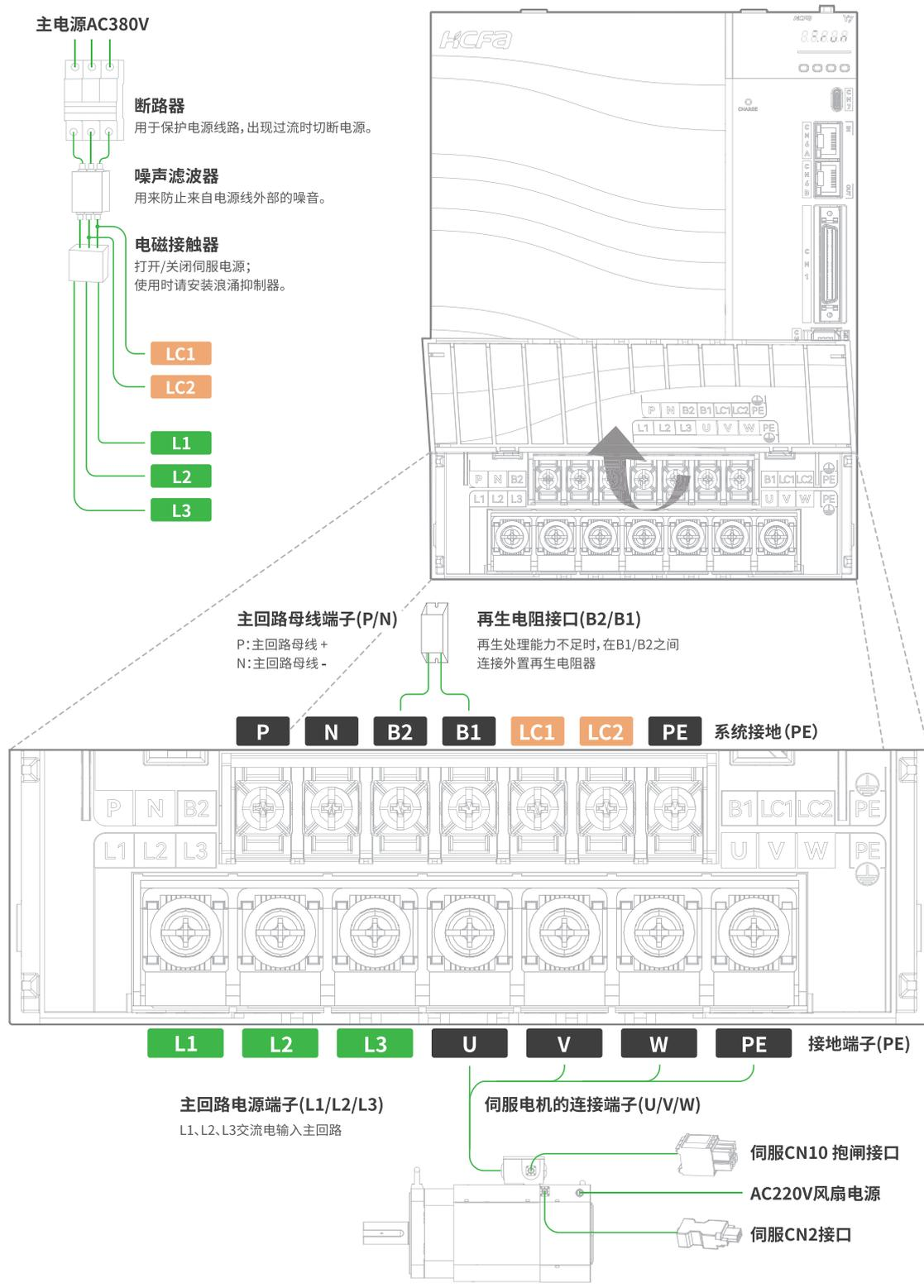
图 1-8 AC380V 11kW/15kW/22kW 伺服单元各部分介绍图 -2
