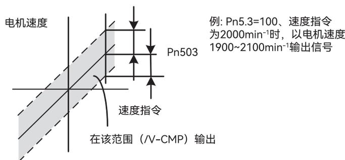
图 5-15 速度一致信号的输出图
