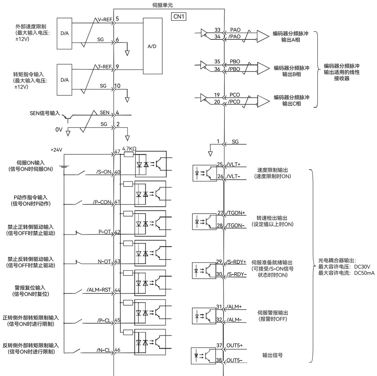
图 2-26 转矩控制时的连接示例图 (脉冲型)
