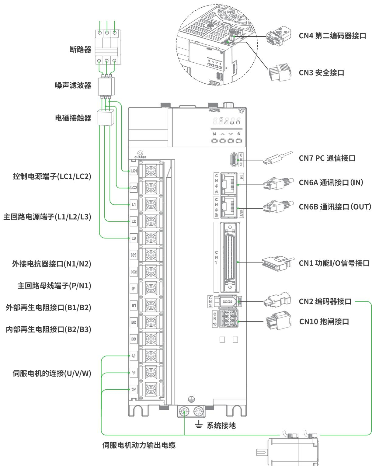
图 2-2 栅栏型端子驱动器端口配线图
