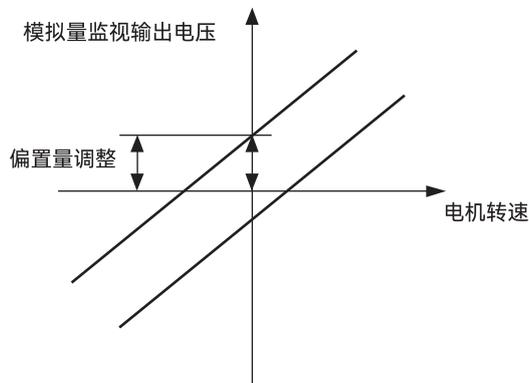
图 7-1 电机转速监视的偏置量调整示例图
