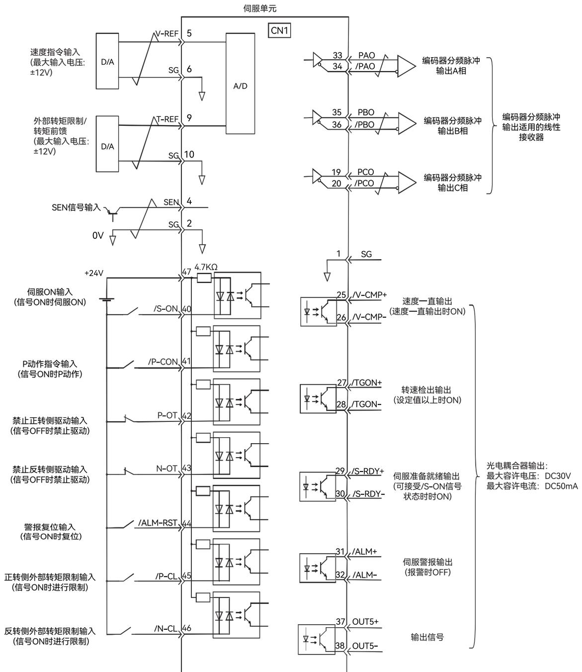
图 2-25 速度控制时的连接示例图 (脉冲型)
