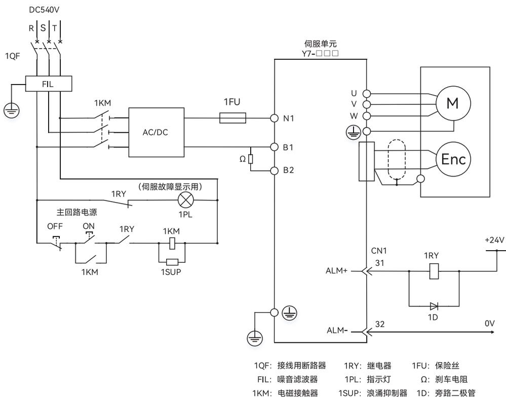
图 2-8 DC540V 输入型 HN-Y7 □□□□□ T-S 三相接线图 1
