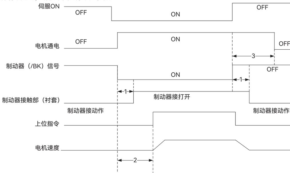
图 5-3 电磁抱闸控制时序图
