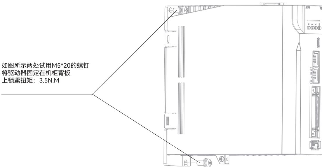
图 1-10 Y7S 伺服单元结构安装示意图
