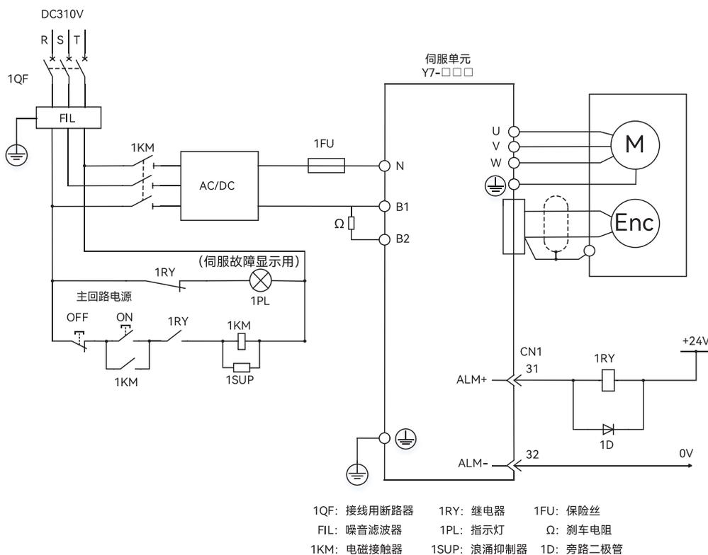
图 2-7 DC310V 输入型 HN-Y7 □□□□□ A-S 接线
