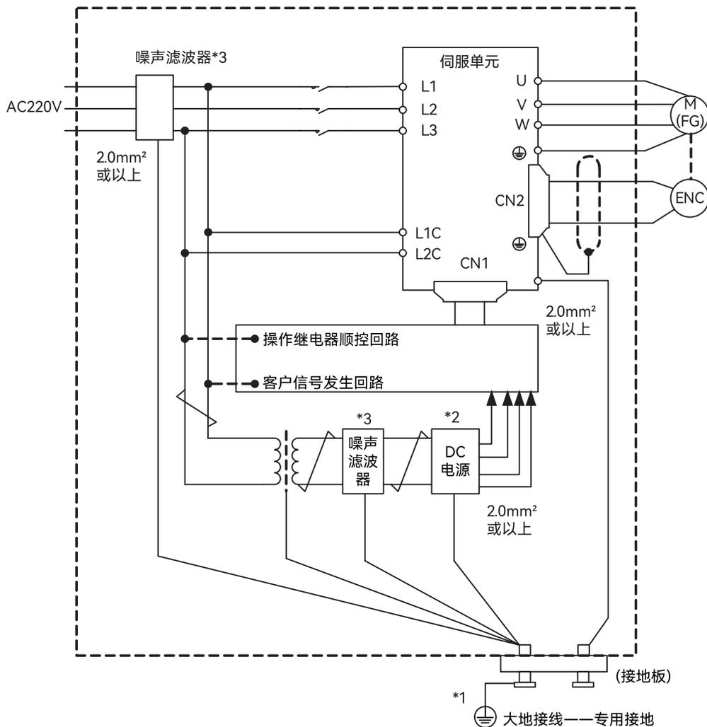
图 2-27 噪音对策的接线示例图
