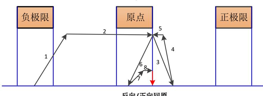
(4). 当工件启动位置处于正极限时，无论回原方向如何设置，其均按反向回原处理
