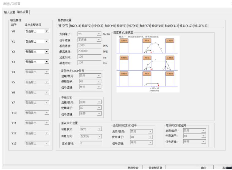
此界面兼容了后面的多路输出设计，最多 12 轴。根据不同的机种不能选中的需要做灰度处理。
