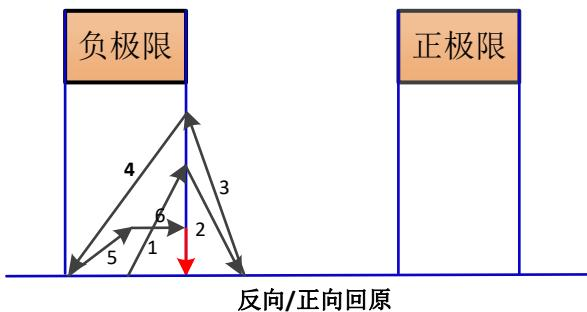
(3). 当工件启动位置处于正极限位置时，无论回原方向如何设置，其均按反向回原处理;
