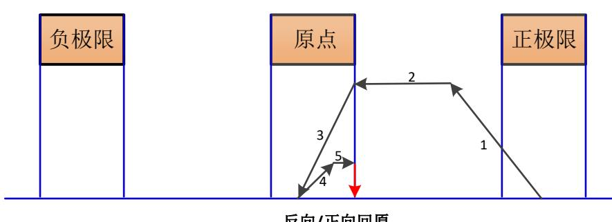
注：由于限位信号由软件触发(受扫描周期影响), Dog 信号由 FPGA 直接采集,
