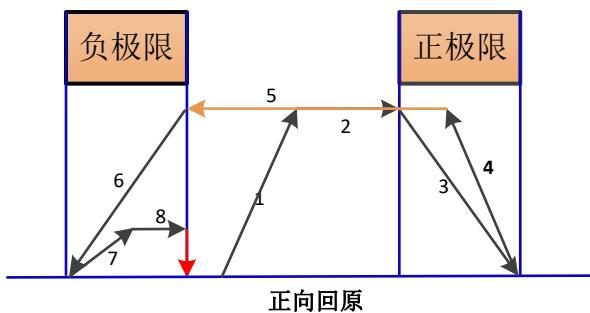
(2). 当工件启动位置处于负极限位置时，无论回原方向如何设置，其均按正向回原处理;
