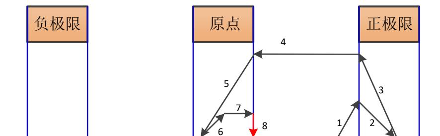
当原点信号触发后,若减速斜率过小,即使工件遇到负限位信号,其仍然按设置斜率减速停止。
