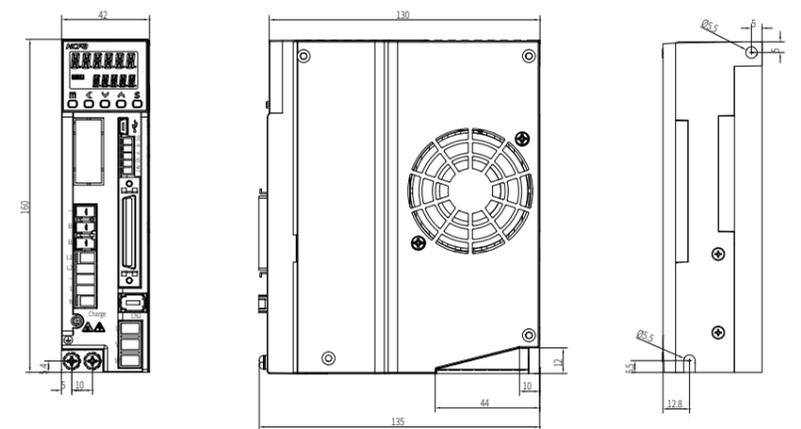
1KW/1.5KW/2KW/2.5KW 驱动器外形尺寸 单位:mm
