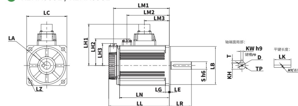
电机规格 1 KW 1.2 KW 1.5 KW 1.8 KW 2 KW
