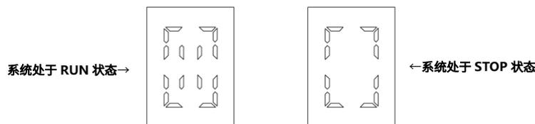
(2) 状态 2：显示 IO 点输入，同时 IN 灯亮，四个数码管的竖线段用来指示 输入点的状态，对应输入点如下图所示：
