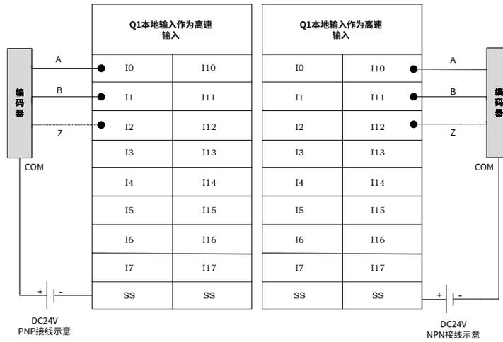
图 14 本地输入作为高速输入外部接线图
