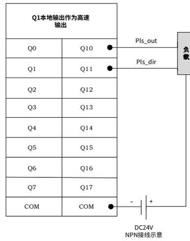
图 16 本地输出作为高速输出外部接线图
