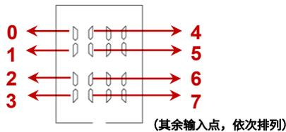
(3) 状态 3：显示 IO 点输出，同时 OUT 灯亮，四个数码管的竖线段用来指示输出点的状态，对应输出点排列方式与输入点排列方式一致。
